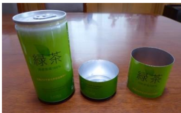
左側；お茶缶 中央と右側；お茶缶をカットし、2個のパーツにする 中央→燃料容器、右側→管の胴部
