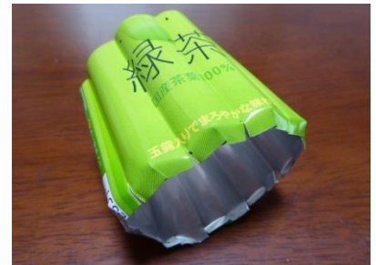
燃料容器の底の形状に応じて片側に5mm~1cmの切れ目を入れ、内側に折る。底がフラットの燃料容器の場合、この加工は不要
